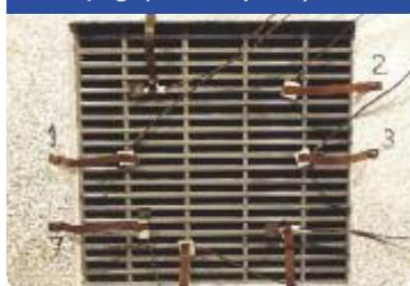
REJILLA antes de la prueba de resistencia al fuego (cara no expuesta)
