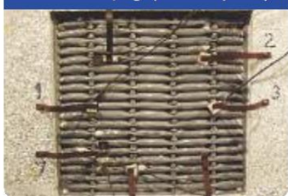
REJILLA tras 30 minutos de prueba de resistencia al fuego (cara no expuesta)
