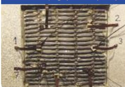
REJILLA tras 60 minutos de prueba de resistencia al fuego (cara no expuesta)
